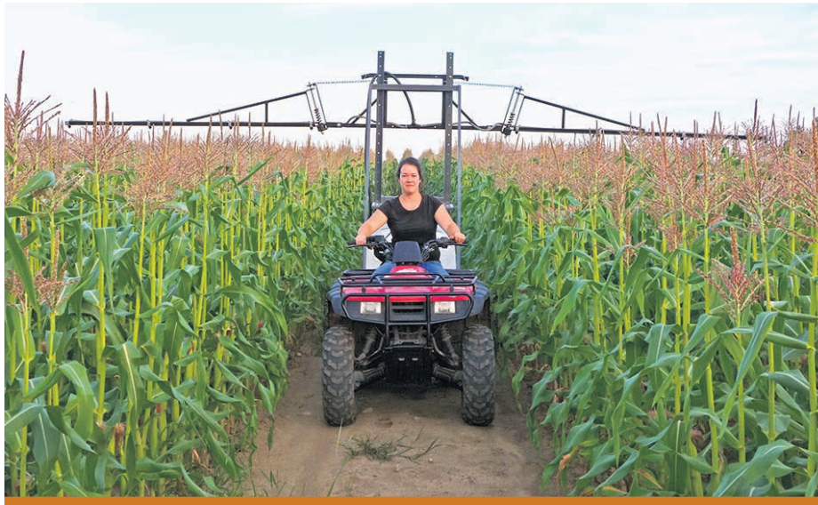
Lors des essais, le prototype de pulvérisation de trichogrammes a permis un contrôle de la pyrale du maïs comparable à celui obtenu avec l'utilisation des trichocartes.
